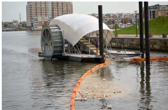
Рисунок 9.10 Два технических решения по задержанию плавучего пластика: а) Плавучая установка из сетей на реке в Австралии (Фото: Bandalong International Pty Ltd) и б) “Мистер Мусорное Колесо” – плавучее боновое заграждение с водяным колесом, работающее на энергии солнца и воды в заливе Балтимор в США (Фото: Адам Линдквист, Waterfront Partnership of Baltimore)
