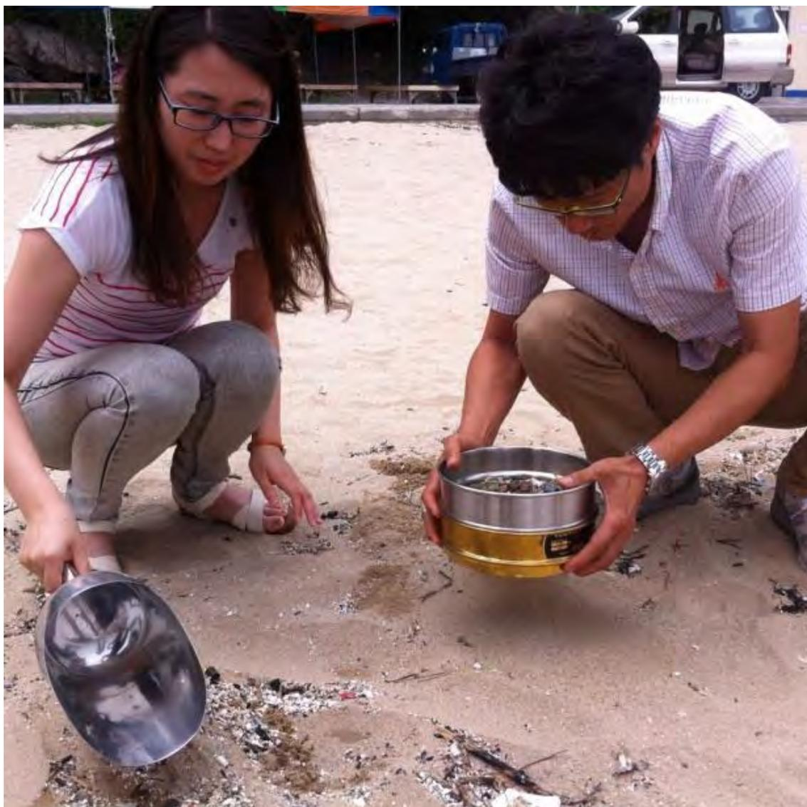
Рисунок 11.1 Взятие проб микропластика из пляжного песка методом сухого просеивания, близ Пусана, Южная Корея, июль 2014. © Питер Кершоу
