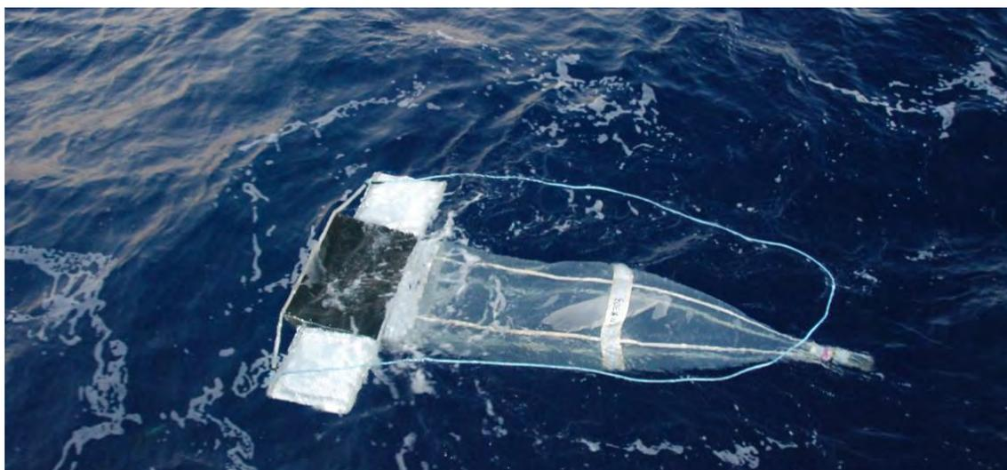
Рисунок 11.2 Буксируемая сеть “манта”, берущая пробы плавящего микропластика с поверхности океана (Новостной архив NOAA)
